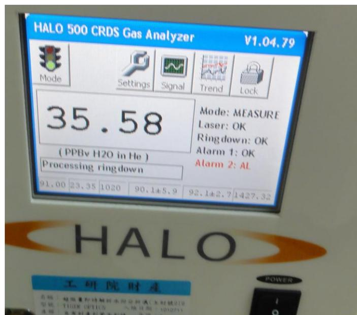
圖十一：光腔衰盪光譜儀分析系統可測定之最低濃度值小於 100 ppb (nmol/mol)
