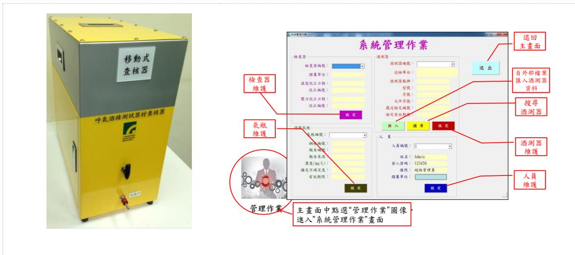
圖 II、移動式氣體濃度查核裝置設計與開發
