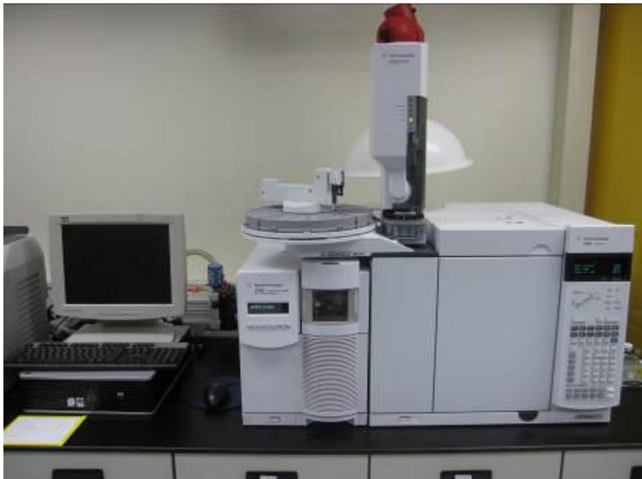
圖三十九：分析系統設備圖 (Agilent GC 7890A-MS 5975C)
