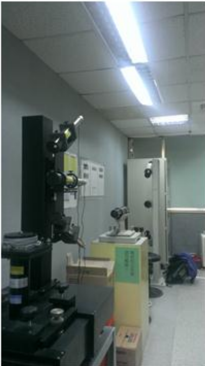
➤ 國土測繪中心之標準量角儀器及鈷原子頻率標準
