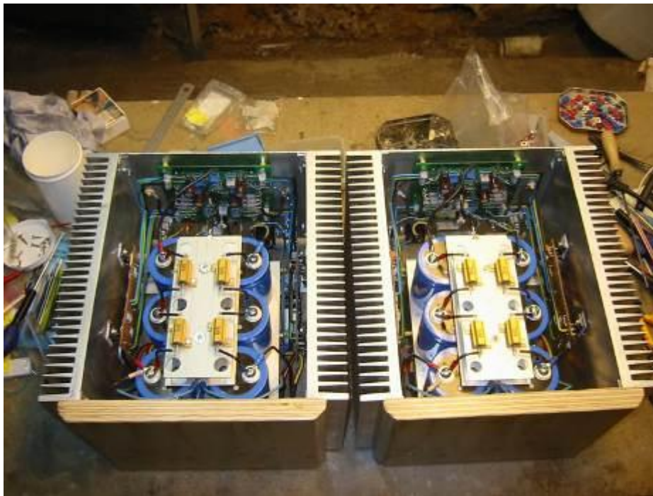
圖 3.13：100W Pass Labs Aleph X
