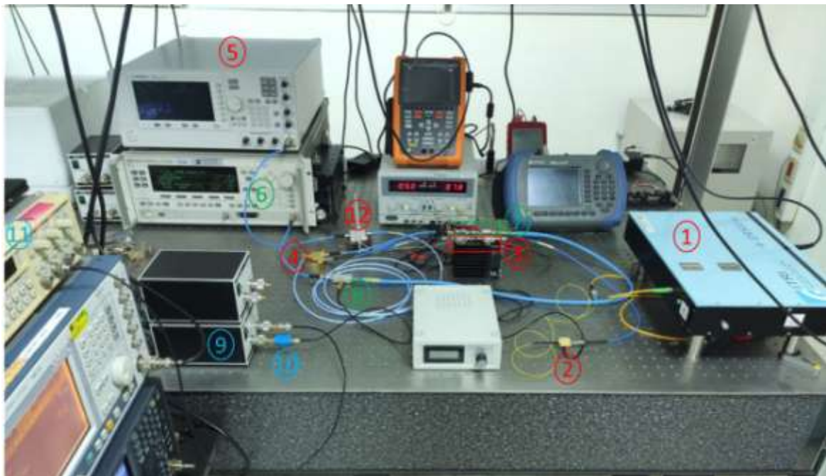
圖 18 使用 50G~75GHz 混波器進行高頻量測實體裝設照片
