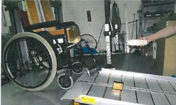
斜坡板(搭配輪椅)的穩態性能測試
