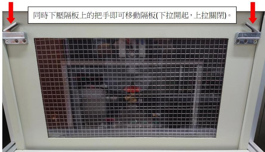
圖5 工作臺隔板操作示意圖
