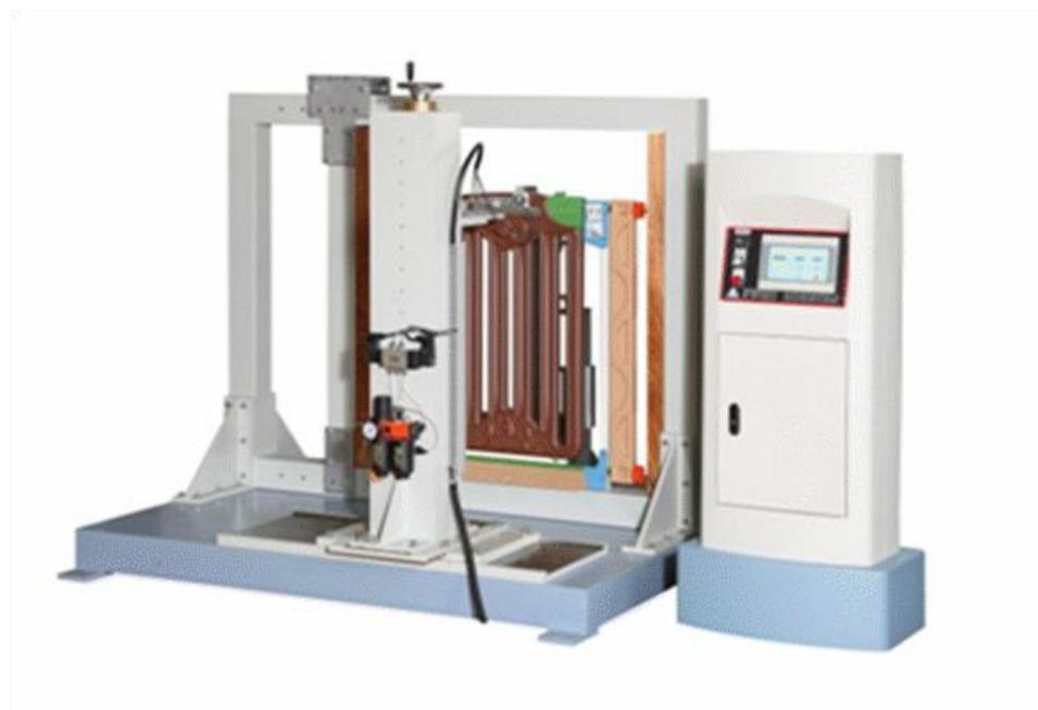
圖 1 搖晃推拉試驗機
