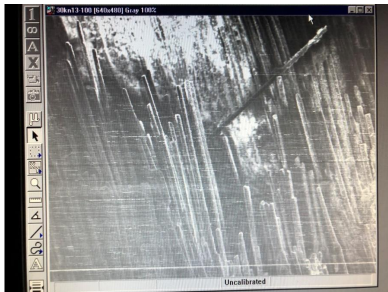
圖 6 0.3 kN 試片正面破壞情形
