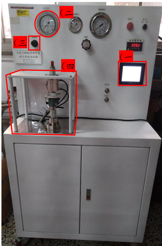
圖2 液夾套式調整器耐久性能測試機
