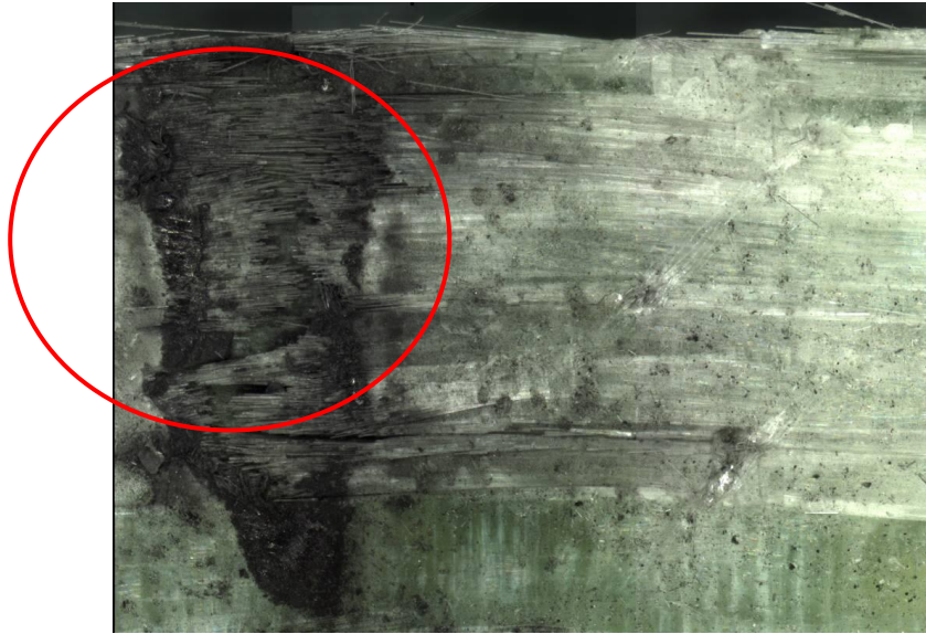
圖 6 0.3 kN 試片正面破壞情形
